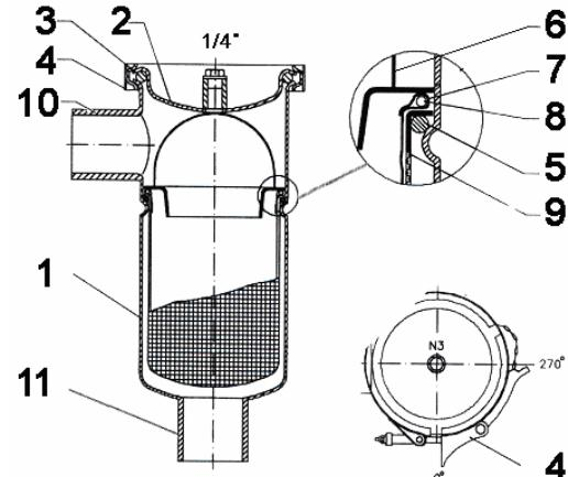
Фильтрующие мешочные элементы поставляются отдельно, согласно необходимому типоразмеру и степени тонкости фильтрации.
